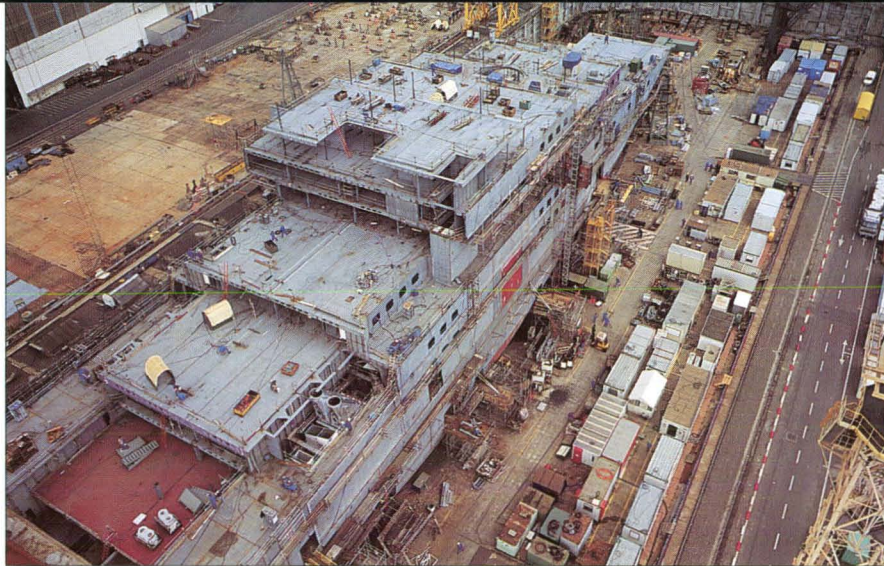
Les NGV ont été construits entièrement en aluminium dans les Chantiers de Saint-Malo, en un peu plus de deux ans.
