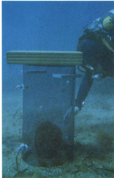
Expérience de mesures de la respiration des Pinnas en plongée. L'animal est placé sous une cloche de volume connu.
